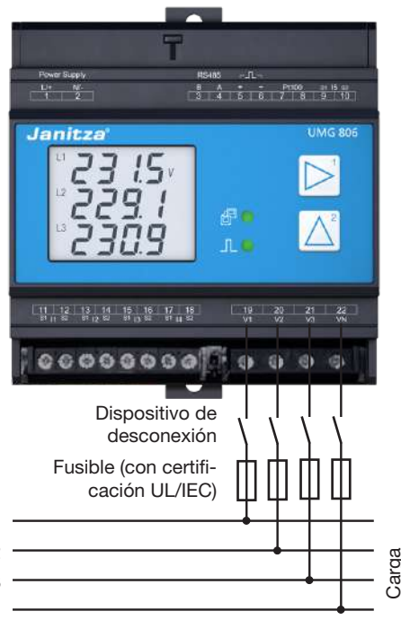
Fig. Ejemplo de conexión "Medición de tensión".
